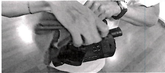
Limpeza en seco a cámara de video
